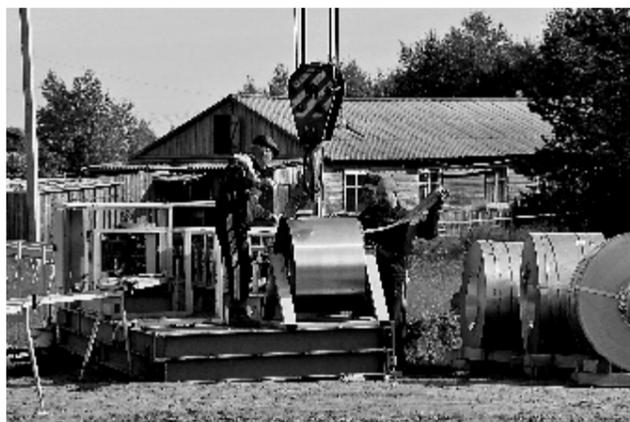
Станок с длинной эстакадой, на котором по специальной технологии изготавливается самонесущая арочная конструкция из двух слоёв.
