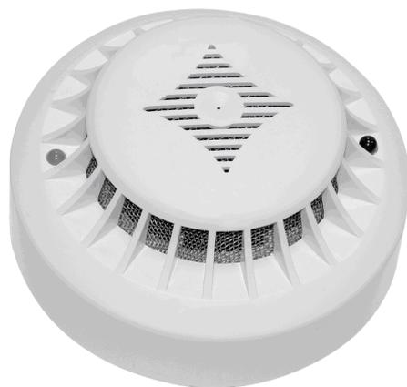
функционирования. Если заряда минимальное количество, и пришло время заменить батарейку, то извещатель начнет мигать световым индикатором. Периодически необходимо, как минимум раз в полгода, снимать и продувать камеру с оптико-электронным датчиком, чтобы избежать ложных срабатываний от осевшей пыли.
